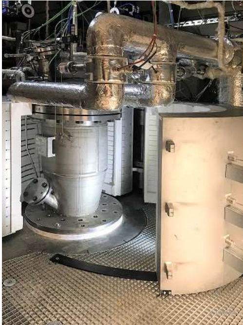
Wirbelschicht-Reaktor mit 30 Liter Volumen (700 Grad Celsius, 6 bar) Fotonachweis: TUMLES (Technische Universität München/Lehrstuhl für Energiesysteme) Download: https://drive.google.com/file/d/1-2TPaklmah2z6Q9DIM-VP9ZFStDpMRdv/view?usp=sharing
