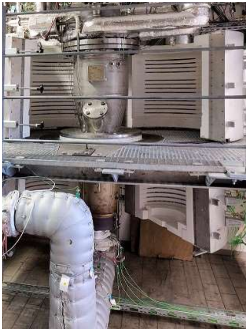
Wirbelschicht-Reaktor mit 30 Liter Volumen (700 Grad Celsius, 6 bar) Fotonachweis: TUMLES (Technische Universität München/Lehrstuhl für Energiesysteme) Download: https://drive.google.com/file/d/1ioy3onyXeQ76GcvSJ1yVbLO3TGis-CsO/view?usp=sharing
