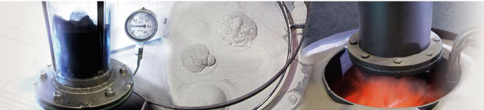
zum Einsatz, die als Multistage-Reaktoren auch zum Kalzinieren oder Trocknen von Pulvern oder Granulaten mit bis zu 150 theoretischen Mischstufen konzipiert sind:
